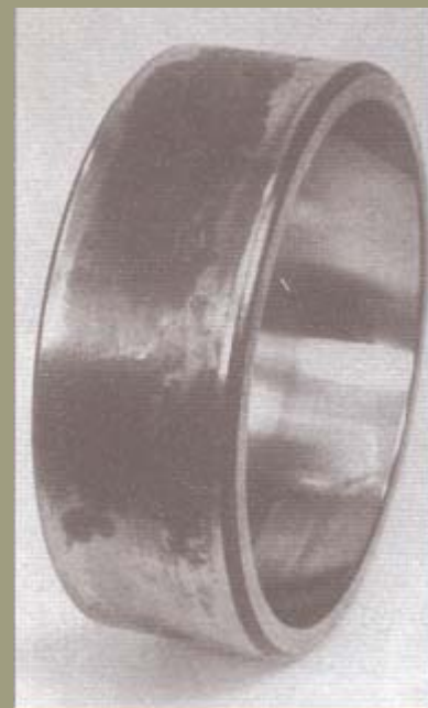
Ruggine di contatto ("fretting corrosion") sull'anello esterno di un cuscinetto orientabile.
