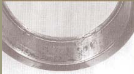
Ruggine profonda sull'anello esterno di un cuscinetto a rulli cilindrici.
