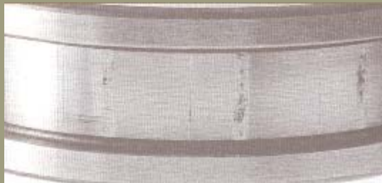
Anello interno di un cuscinetto a rulli cilindrici danneggiato da vibrazioni. Il danneggiamento si è verificato quando il cuscinetto non era in rotazione. Dalle tracce più lievi esistenti tra gli avvallamenti più pronunciati (e con corrosioni sul fondo) è evidente che l'anello per brevi periodi ha mutato posizione.
